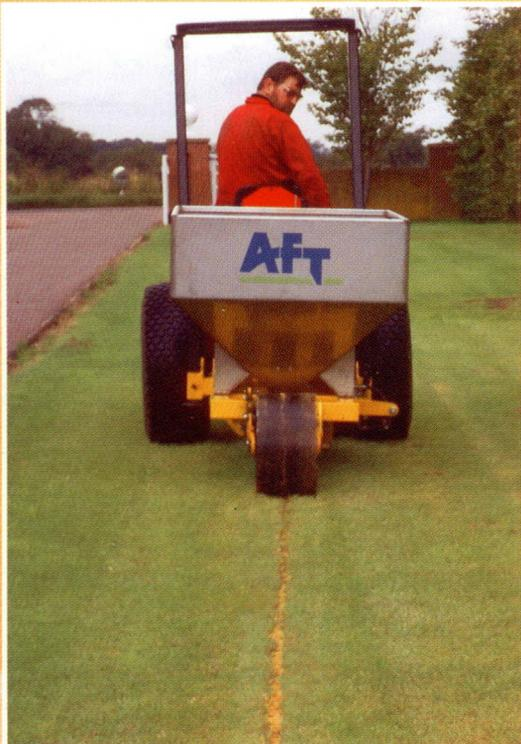
**DER AFT SANDBANDER ERSTELLT IN KÜRZESTER Zeit 25 mm breite Drainageschlitzte und befüllt diese gleichzeitig mit Sand bis zur einer Tiefe von 250 mm.**
